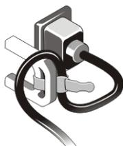
**Figura 6. Fissaggio del cavo di alimentazione**
