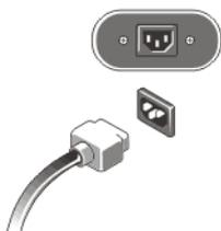
**Figura 5. Collegamento dell'alimentazione**
