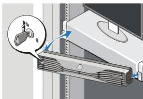
**Figura 8. Installazione della cornice anteriore**
